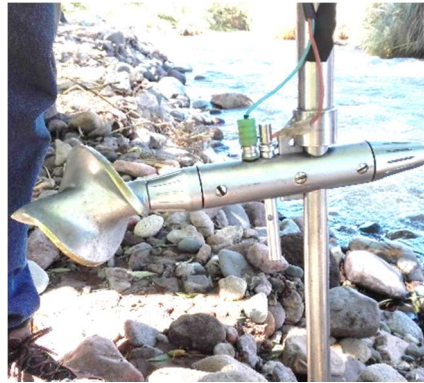
Imagen 31. Molinete utilizado por el Departamento de Hidrología.
