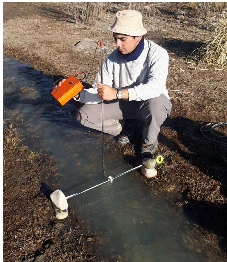
Imagen 38. Aforo con micromolinete en una Toma del Río Las Tunas (Tunuyán Superior, Tupungato)
