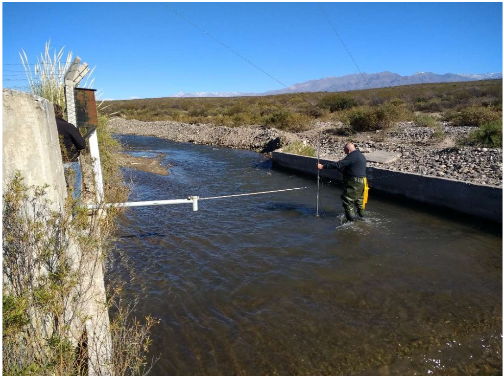
Imagen 34. Aforo con molinete en Arroyo Awanda (Tunuyán Superior, San Carlos).
