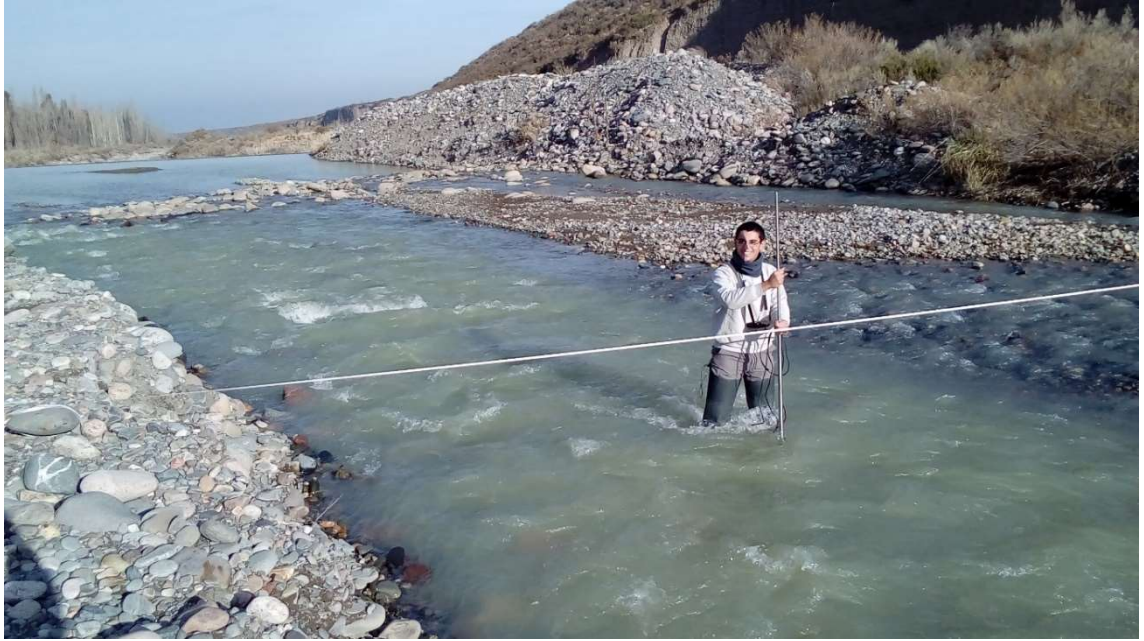
Imagen 35. Aforo con molinete en Río Las Tunas (Tunuyán Superior, Tupungato)
