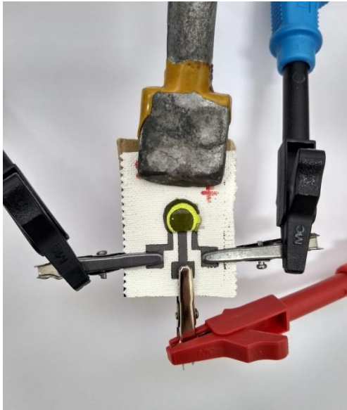
Figura 2. Sistema de contato entre o dispositivo em esparadrapo e o potenciostato a partir de plugs do tipo jacaré, sustentando uma gota de 90 \mu\text{L} .
