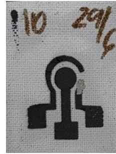
Figura 3. Versão final do dispositivo sobre a superfície de esparadrapo contendo contra eletrodo, eletrodo de trabalho e eletrodo referência de prata.
