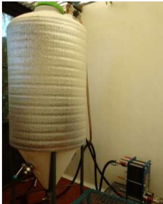
Figura N°1.11: Fermentador de 500L con aislante térmico
