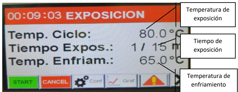
Figura N°11: Pantalla del pasteurizador durante etapa de mantenimiento
