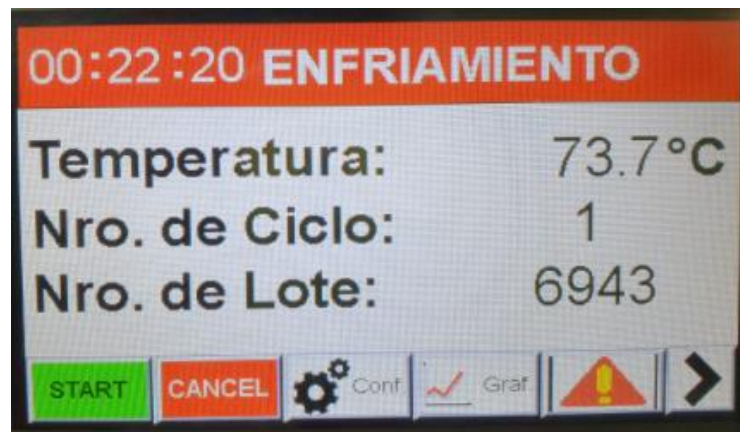
Figura N°12: Pantalla del pasteurizador durante etapa de enfriamiento
