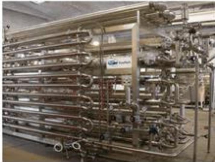
**Figura 9:** Intercambiador de calor tubular.
