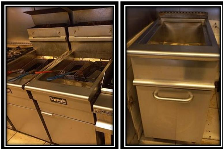
Figura 10. Dos freidoras con sus respectivos canastos a la izquierda y un hervidor de pasta a la derecha.
