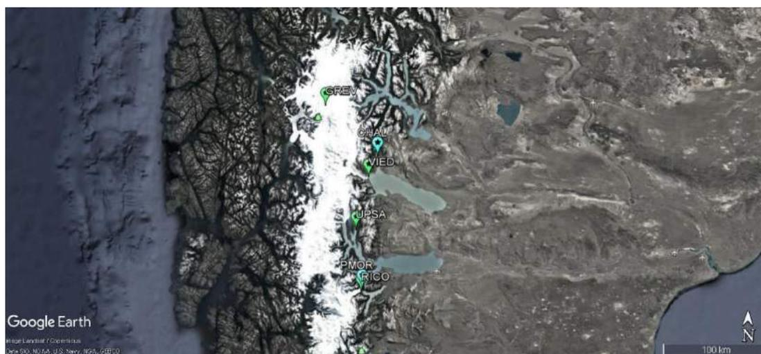
Figura 3.2. Distribución espacial de la micro-red sísmica diseñada por el departamento de Geomática IANIGLA – CONICET diseñada para el monitoreo de la actividad sísmica y volcánica. Los íconos coloreados en blanco se refieren a las estaciones ya instaladas (CHAL y PMOR), mientras que en verde aquellas que han sido proyectadas pero que aún falta ser instaladas. (GREV, VIED, UPSA, RICO)
