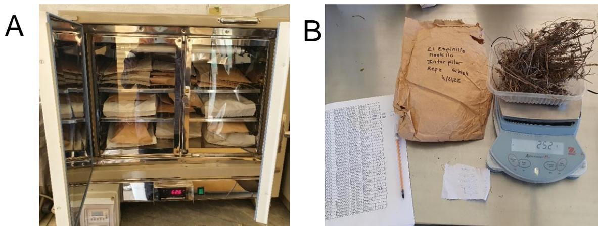
Figura 5. A. Estufa utilizada para la eliminación del contenido de humedad de las muestras B. Balanza electrónica utilizada para el pesado de las muestras. (Autor: Marco Vallebella)
