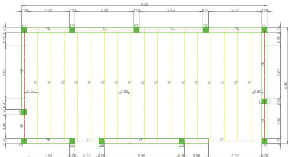
Fig. 4: Planta de estructura de la cubierta.
