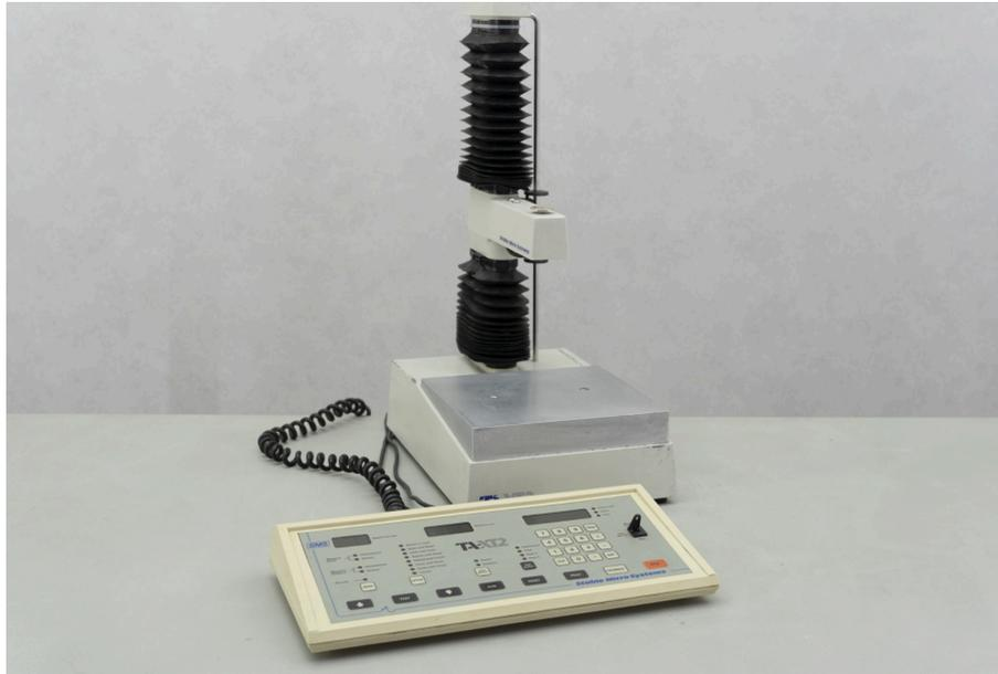
Figura 3.5 - Analizador de textura TA.XT2i. Equipo pionero en el análisis instrumental de textura, desarrollado por Stable Micro Systems en 1989. Originalmente diseñado con una célula de carga de 25 kgF y panel de control integrado, permite realizar ensayos autónomos o conectados al software XTRA Dimension. Su versatilidad proviene de la amplia gama de sondas y accesorios desarrollados para aplicaciones diversas.
