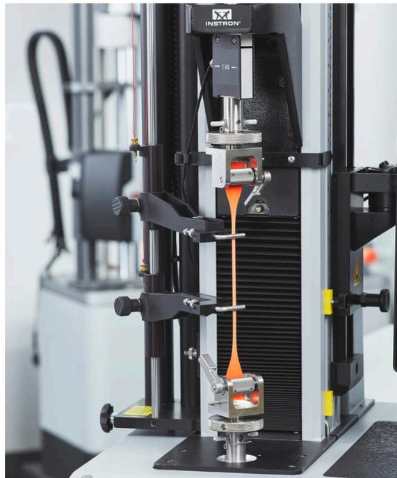
Figura 2.7 - Ensayo de tracción finalizado de una probeta polimérica. Se utiliza un extensómetro de largo recorrido para medir la elongación del espécimen. Crédito: Instron. Fuente:
