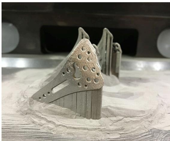
Figura 2.2 - Implantes de metales amorfos, placas para radio, impresos mediante tecnología SLS. Se adaptan a los movimientos de los huesos y facilitan el proceso de curación. Fuente: Heraeus. [Amorphous metals for medical technology](#).
