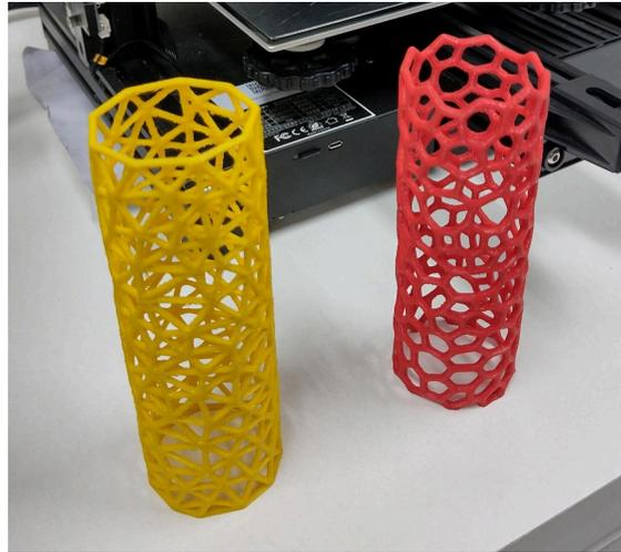
Figura 4.5 - Prototipos impresos en PLA. En esta etapa se notó el efecto sobre los bordes.
