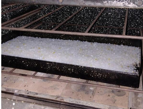
Figura 4.7 - Secado del gel de sílice en un horno. Este proceso fue realizado en dos ocasiones a lo largo del proyecto.
