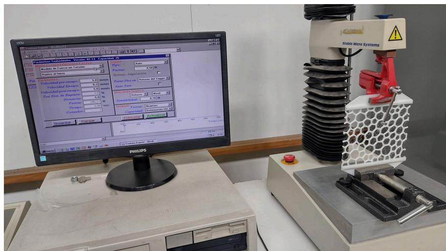
Figura 4.14 - Ensayo en curso. Nótese la naturaleza de los accesorios, los cuales difieren en dimensiones. El superior posee un área de contacto más concentrada en el centro de la probeta, que deformaría de manera irregular una probeta sin extremos rígidos.
