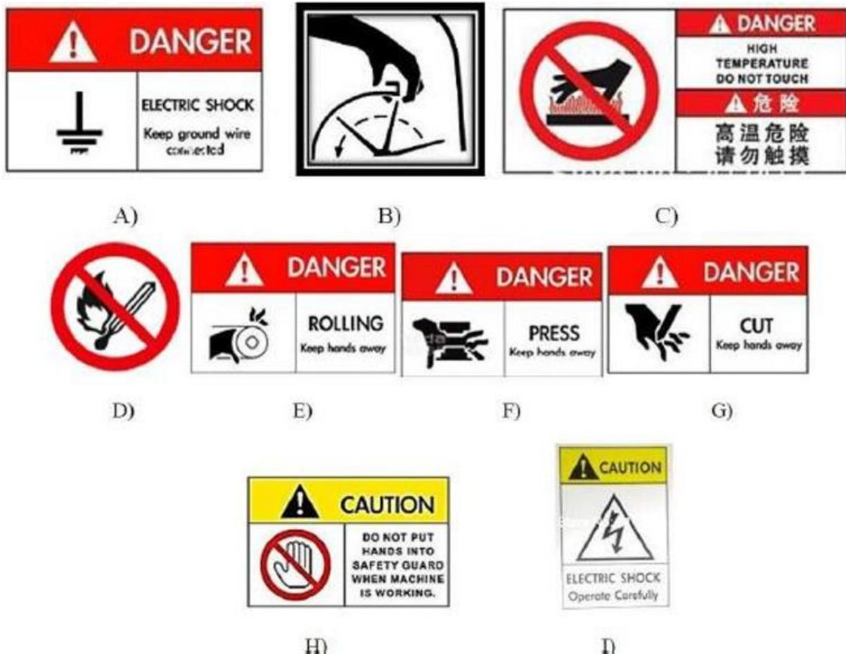
Figura 10.4 Señales de seguridad que deben encontrarse en las máquinas
