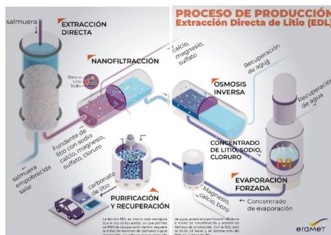
Figura 6.1 Esquema de una planta Extracción Directa de Litio (DEL)
