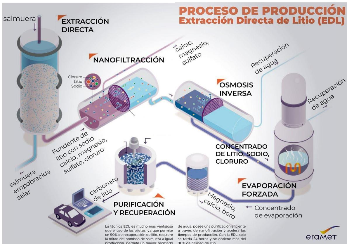
Figura 3.6 Proceso de producción - Extracción Directa de Litio (DEL) mediante Nanofiltración
