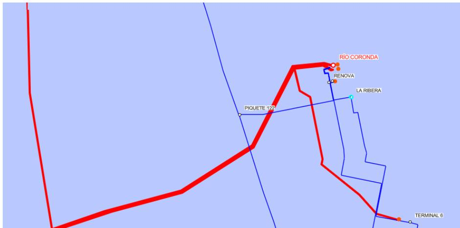
Ilustración 5.5-4 - Red eléctrica de alta y mediana potencia | Fuente - CAMMESA, SAI
