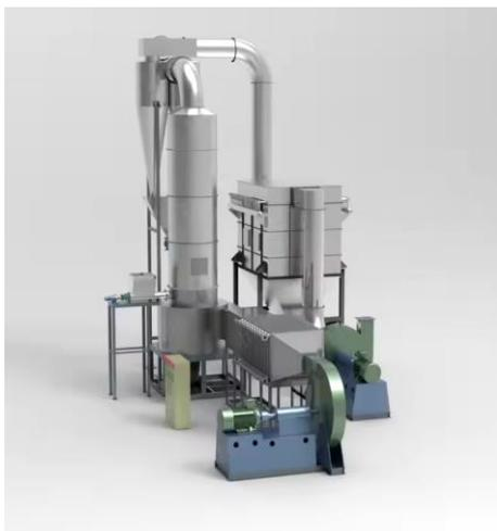
*Figura: 34 Equipo de secado instantáneo XSG-10*
