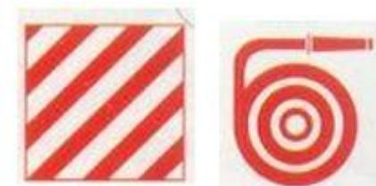
Figura: 68 Señalización de nichos hidrantes, Fuente: IRAM 10005.pdf (ciscal.com.ar)
