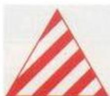
Figura: 66 Señalización de ubicación del matafuego, Fuente: IRAM 10005.pdf (ciscal.com.ar)
