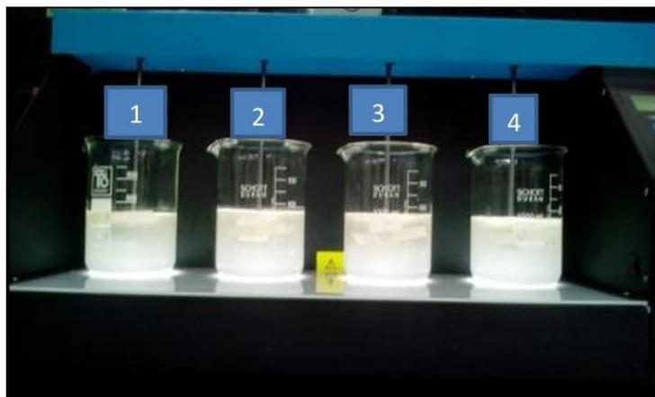
Ilustración 6.3.3.2: Test de jarras con hidróxido de sodio como neutralizante y sulfato de aluminio como coagulante /Fuente: Propuesta de mejora del sistema de tratamiento de aguas residuales - Carlos Melo, Bogotá.
