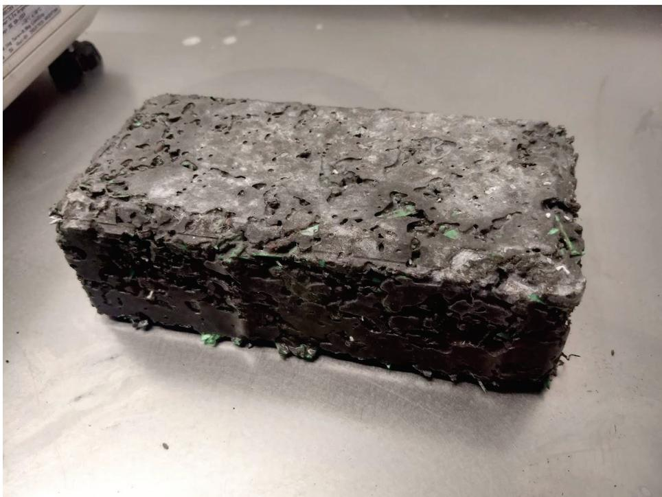
Figura 45. Adoquines mal conformados
