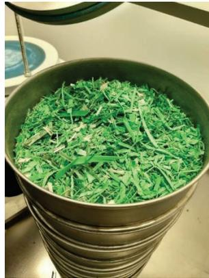
*Figura 35. Material colocado en la serie de tamices.*
