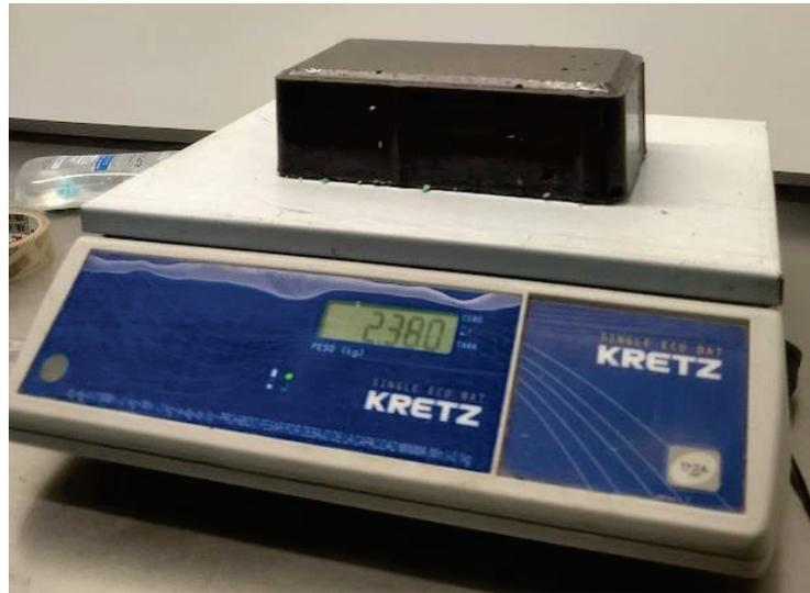
Figura 48. Pesaje de adoquín en estado SSS en balanza.
