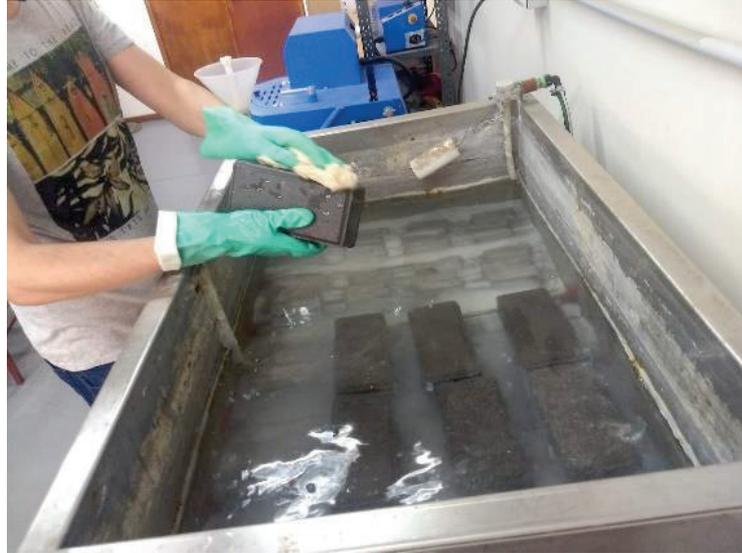
*Figura 46. Adoquines siendo retirados del tanque de curado del laboratorio del CEIRS luego de haber permanecido 28 días para que adquieran su máxima resistencia. Se observa que se está retirando la humedad superficial para dejar los adoquines en estado SSS*
