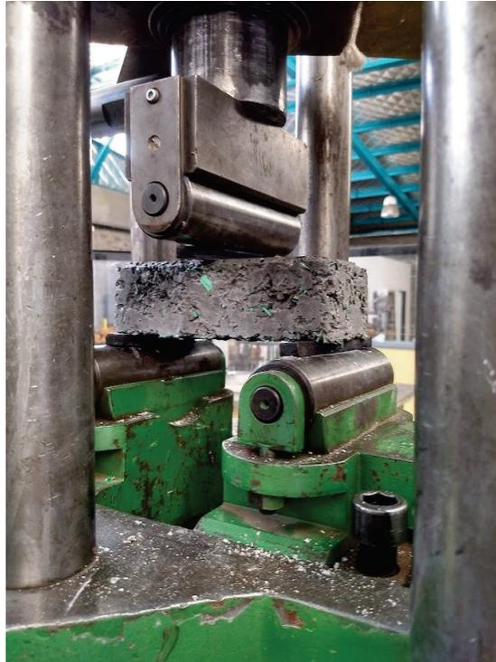
*Figura 50. Adoquín con alto contenido de flejes de PET triturado siendo ensayado a flexión en la máquina universal de ensayos.*
