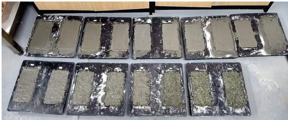
Figura 39. Adoquines conformados
