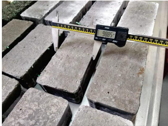
Figura 42. Medición de las dimensiones de los adoquines utilizando un calibre electrónico.
