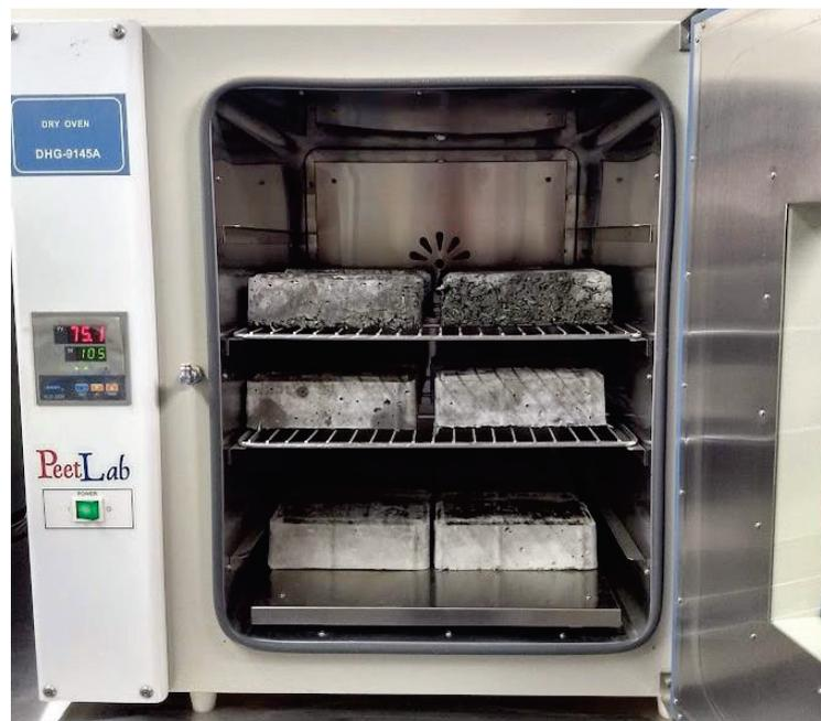
Figura 49. Secado de adoquines en el horno del laboratorio del CEIRS.
