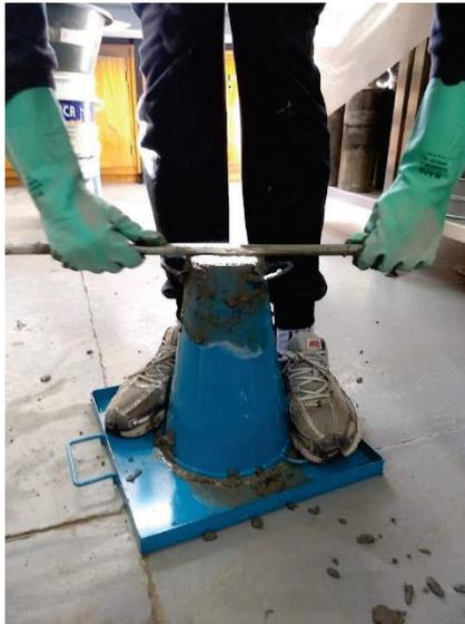
Figura 38. Enrasamiento mediante varilla lisa de acero de la mezcla dentro del cono Abrams.
