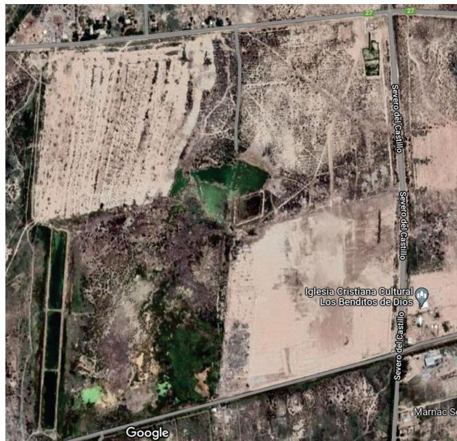
Figura 4. Acercamiento del sitio de emplazamiento. El área destinada al vertedero está compuesta por las 3 parcelas casi rectangulares. Note las lagunas de estabilización en la esquina inferior izquierda.
