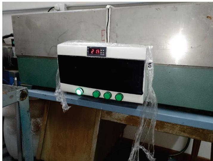
Figura 41. Control de temperatura del agua del tanque.
