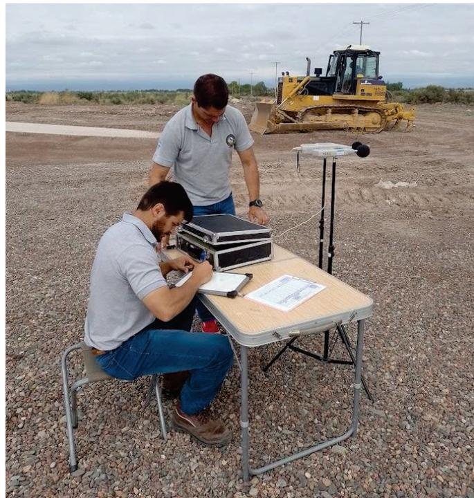
*Figura 20. Instalación del equipo de medición de ruido.*
