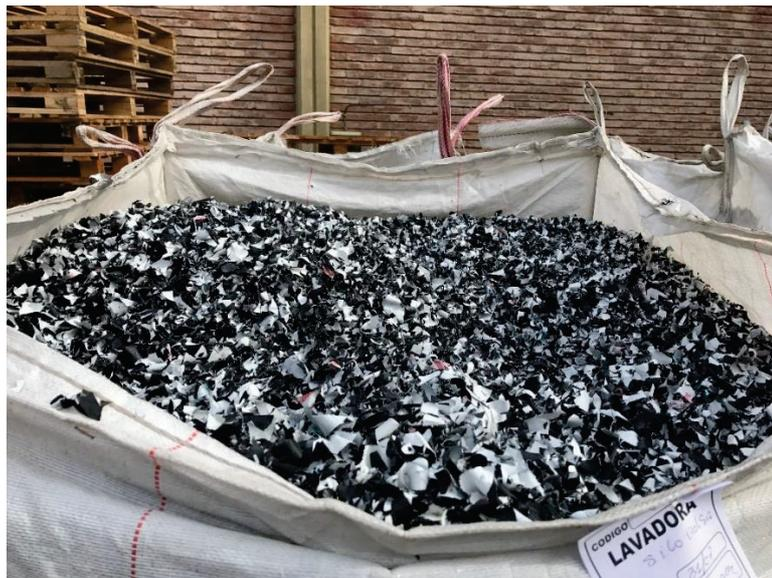
*Figura 58. Residuos plásticos triturados listos para ser fundidos y, posteriormente, convertidos en materia prima.*
