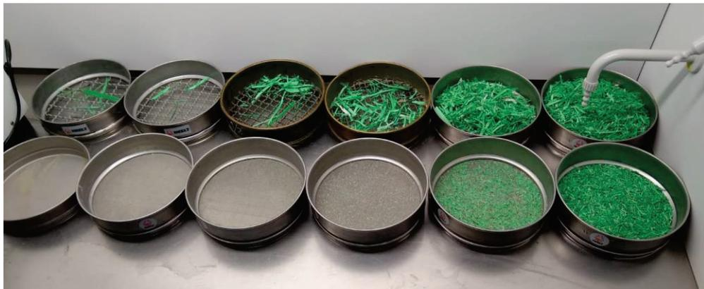
*Figura 36. Distribución por tamaños lograda a partir de una combinación de tamizado manual y tamizado mecánico.*
