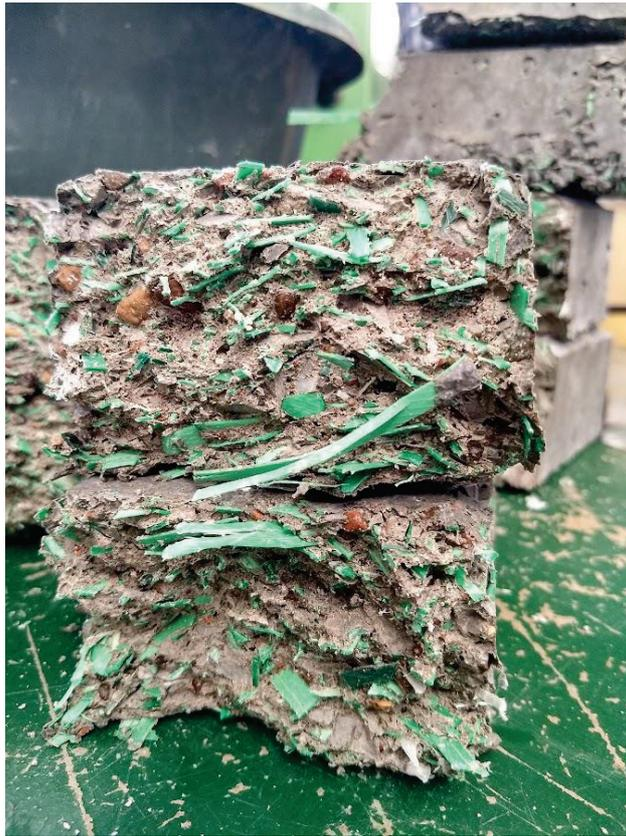
*Figura 51. Adoquín con incorporación de flejes de PET triturado luego del ensayo de flexión.*
