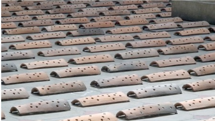
Ilustración 34 – Detalle de “Tejas musleras con goteras”, Ciudad de México, 2004.
