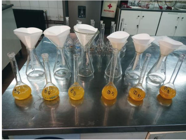
Figura N° 4. Muestras con agregado de agua destilada y acetato de plomo listas para enrasar y filtrar. Para determinación de azúcares reductores.
