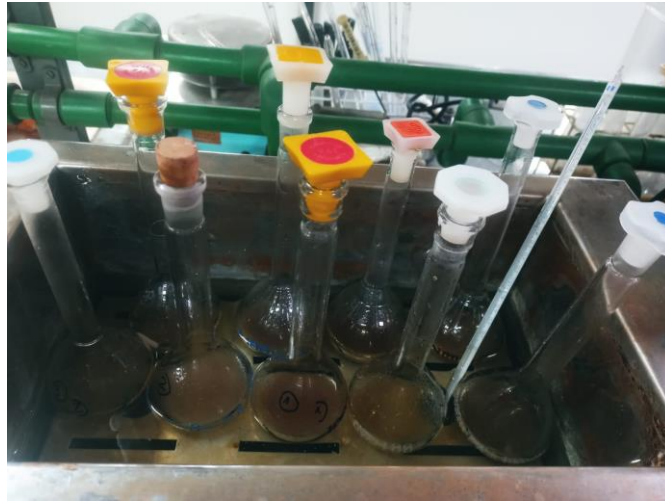
Figura N° 6. Muestras con agregado de agua destilada y ácido clorhídrico concentrado en baño María a 70 °C. Para determinación de azúcares totales.
