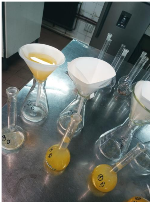
Figura N° 5. Muestras con agregado de agua destilada y acetato de plomo y enrasadas, listas para filtrar. Para determinación de azúcares reductores.
