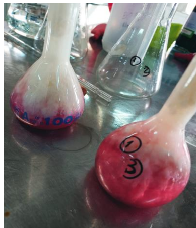
Figura N° 7. Muestras neutralizadas con hidróxido de sodio al 30 %, con el agregado de acetato de plomo para su defecación y enrasadas para luego filtrar y obtener la solución con la que se tituló el licor de Fehling en la determinación de azúcares totales.
