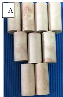
Figura N° 7: A. Se visualizan las probetas que debieron ser descartadas por la dispersión de los valores durante la experiencia.
