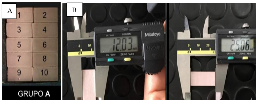
Figura N° 3: Probetas para ensayos Grupo A preparadas con agua bidestilada. B Control de medidas de las probetas mediante calibre analógico 150 mm / 6" - 0.05 mm / 1/128" - 530-104 (Mitutoyo). Nota: probetas realizadas según normativas ISO.
