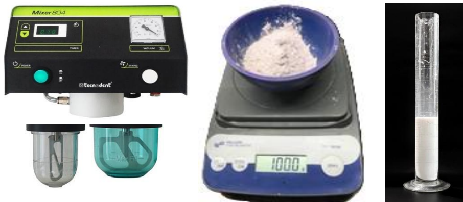
Figura N°1: Equipamiento: Mezcladora de vacío. Balanza de precisión. Probeta de vidrio, calibrada, con polímero.
