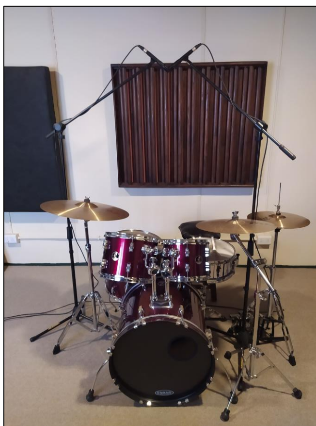
Fig. 22. Jazz X/Y - 07 - 107cm, 107°, centro batería. Imagen de elaboración propia.
