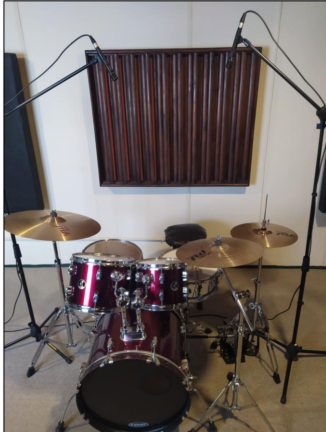
Fig. 35. Funk A/B - 01 - 110cm, I-D centro redoblante, I borde hat D borde tom piso. Imagen de elaboración propia.
