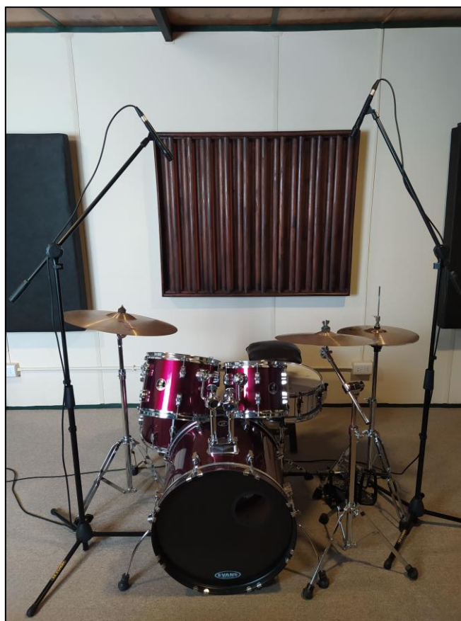
Fig. 25. Jazz A/B - 01 - 110cm, I-D centro redoblante, I borde hat D borde ride. Imagen de elaboración propia.
