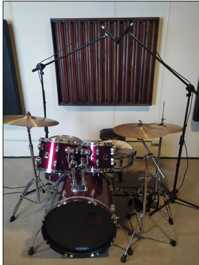
Fig. 60. Metal X/Y - 01 - 90cm, 90°, centro redoblante. Imagen de elaboración propia.
