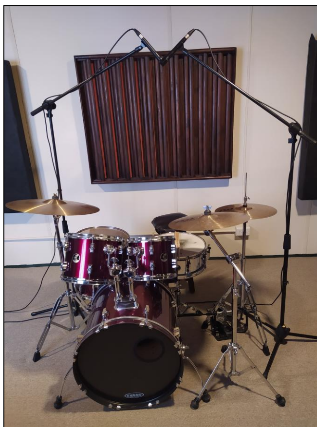
Fig. 41. Reggae X/Y – 01 - 105cm, 90°, centro redoblante. Imagen de elaboración propia.
