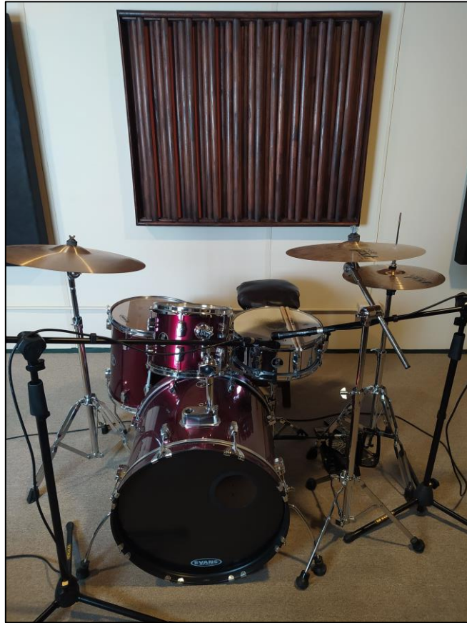
Fig. 62. Metal X/Y - 04 - 32cm, 90°, frente redoblante, sobre bombo. Imagen de elaboración propia.
