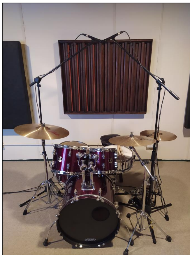
Fig. 24. Jazz X/Y - 09 - 107cm, 135°, aro redoblante. Imagen de elaboración propia.
