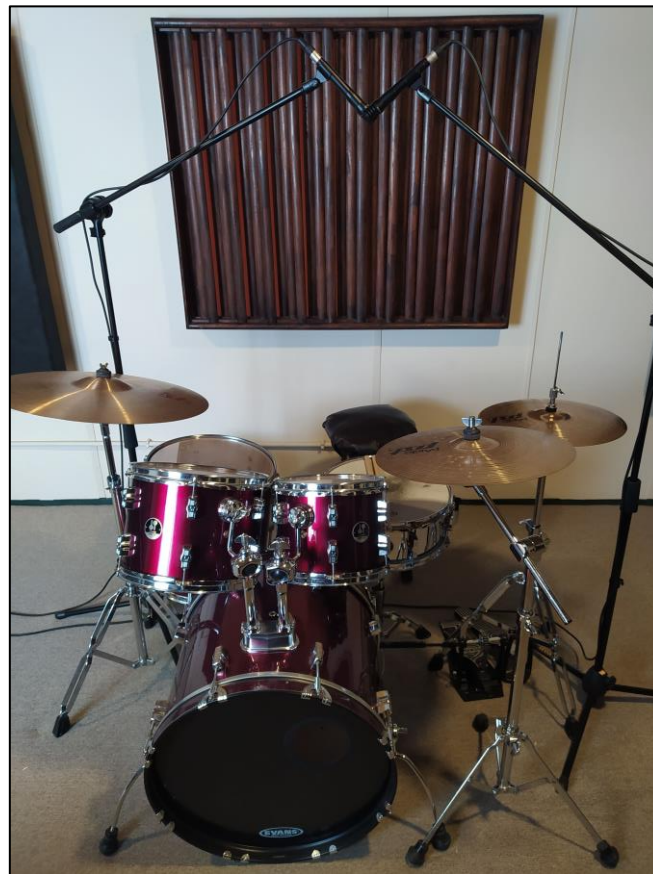
Fig. 42. Reggae X/Y - 03 - 90cm, 95°, centro redoblante. Imagen de elaboración propia.
