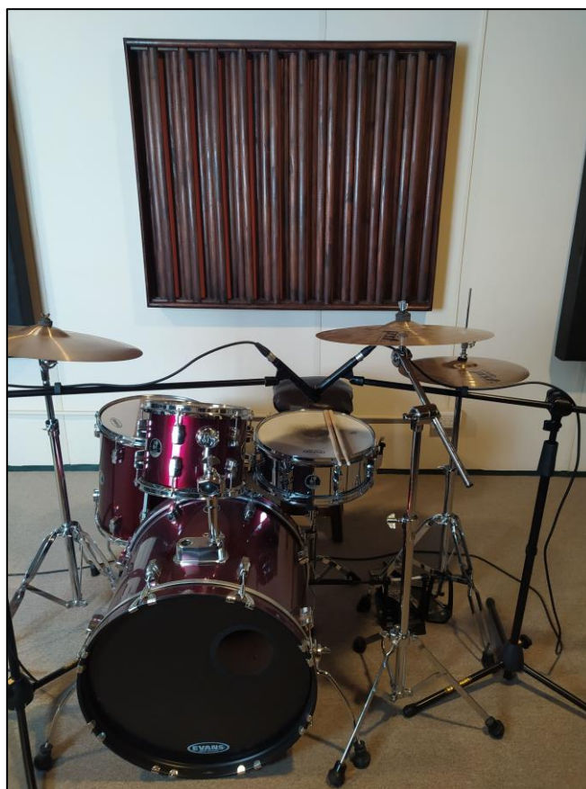
Fig. 63. Metal X/Y - 05 - 33cm, 95°, frente redoblante, sobre bombo, más alto. Imagen de elaboración propia.
