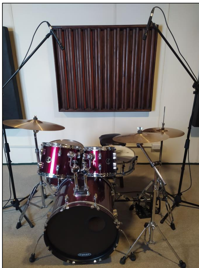
Fig. 45. Reggae A/B - 01 - 100cm, I-D centro redoblante, I borde hat D borde ride. Imagen de elaboración propia.
