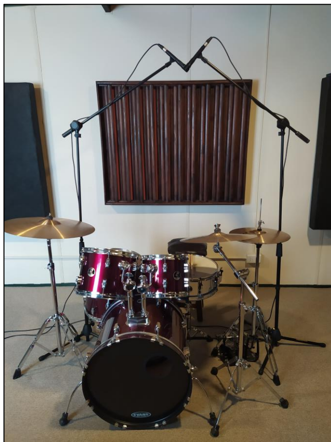
Fig. 19. Posición inicial de micrófonos para grabación de jazz (Jazz X/Y - 01 - 115cm, 90°, centro redoblante). Imagen de elaboración propia.
