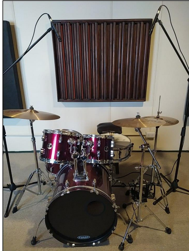
Fig. 64. Metal A/B - 01 - 100cm, I-D centro redoblante, I hat D borde interior ride. Imagen de elaboración propia.
