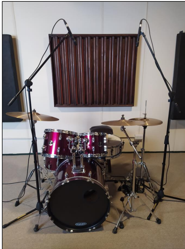
Fig. 27. Jazz A/B - 04 - 101cm, I borde hat D centro redoblante, I borde hat D pedal bombo. Imagen de elaboración propia.
