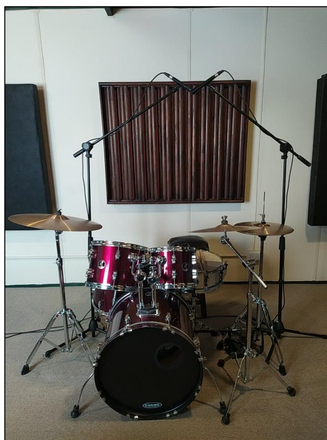
Fig. 20. Jazz X/Y - 03 - 100cm, 115°, centro redoblante. Imagen de elaboración propia.
