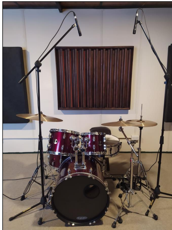
Fig. 28. Jazz A/B - 06 - 120cm, I borde hat D centro redoblante, I borde hat D pedal bombo. Imagen de elaboración propia.
