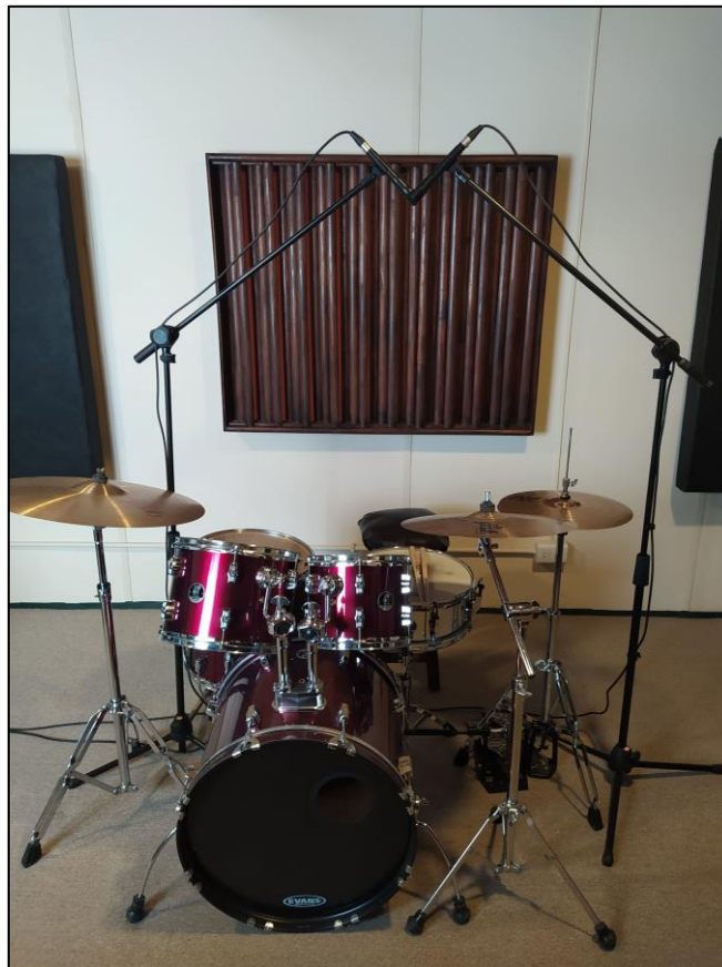
Fig. 31. Funk X/Y - 03 - 100cm, 90°, centro redoblante. Imagen de elaboración propia.
