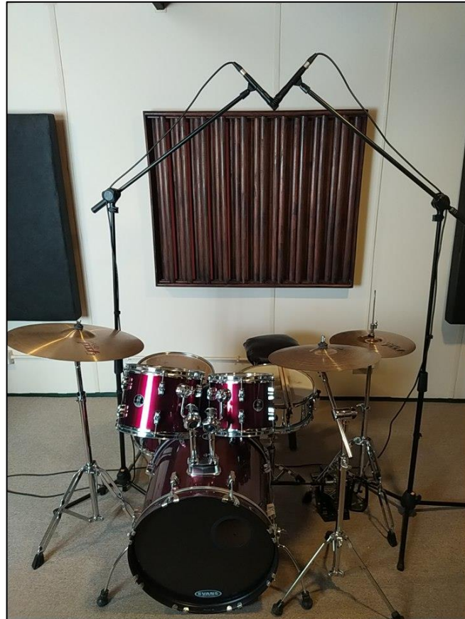
Fig. 30. Funk X/Y - 01 - 115cm, 90°, centro redoblante. Imagen de elaboración propia.
