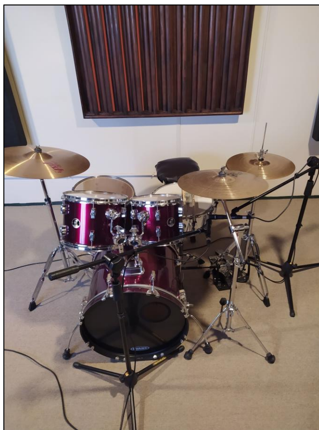
Fig. 33. Funk X/Y - 07 - 35cm, 90°, parche superior redoblante, 15cm bombo. Imagen de elaboración propia.
