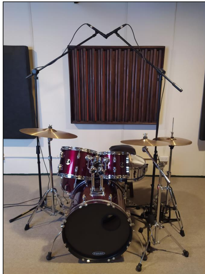
Fig. 21. Jazz X/Y - 05 - 115cm, 115°, centro batería. Imagen de elaboración propia.
