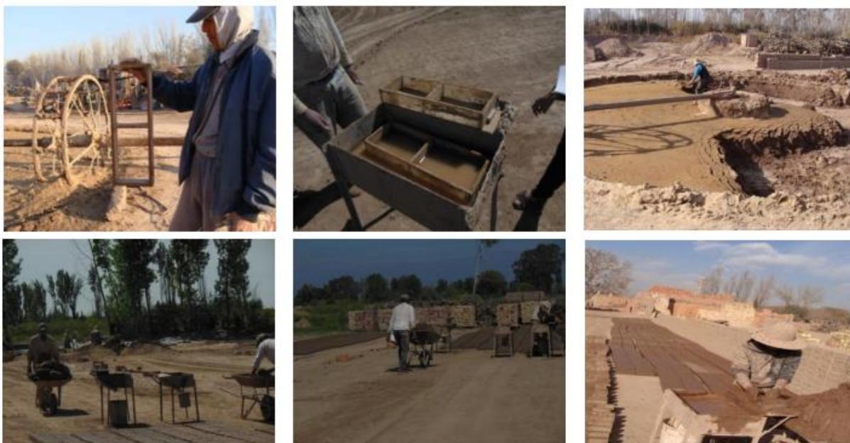
Figura 4. Proceso de moldeado de ladrillos Fuente: Estudio Socioambiental de la Producción de Ladrillos Artesanales en Mendoza desde la Perspectiva del Análisis de Ciclo de Vida (UTN)
