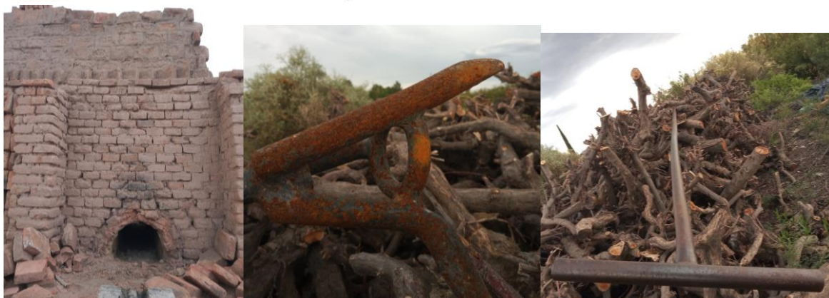
Figura 8. Bocas del horno y lanza tronqueadora. Fuente: Elaboración Propia
