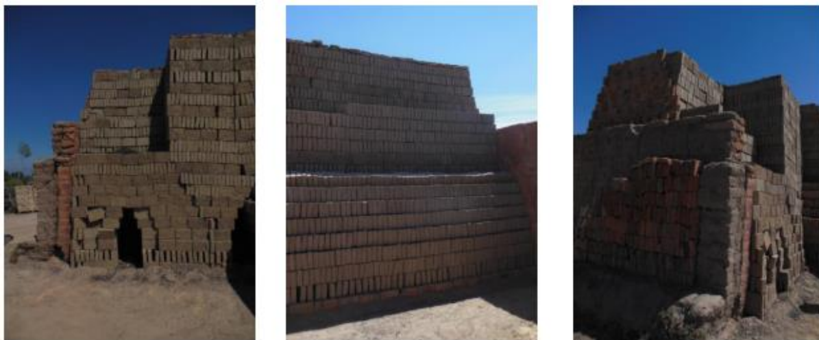
Figura 6. Banqueteada de ladrillos. Fuente: Estudio Socioambiental de la Producción de Ladrillos Artesanales en Mendoza desde la Perspectiva del Análisis de Ciclo de Vida (UTN)
