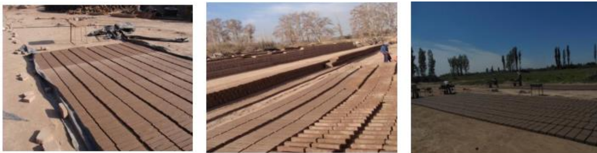
Figura 5. Secado de los adobes. Fuente: Estudio Socioambiental de la Producción de Ladrillos Artesanales en Mendoza desde la Perspectiva del Análisis de Ciclo de Vida (UTN)
