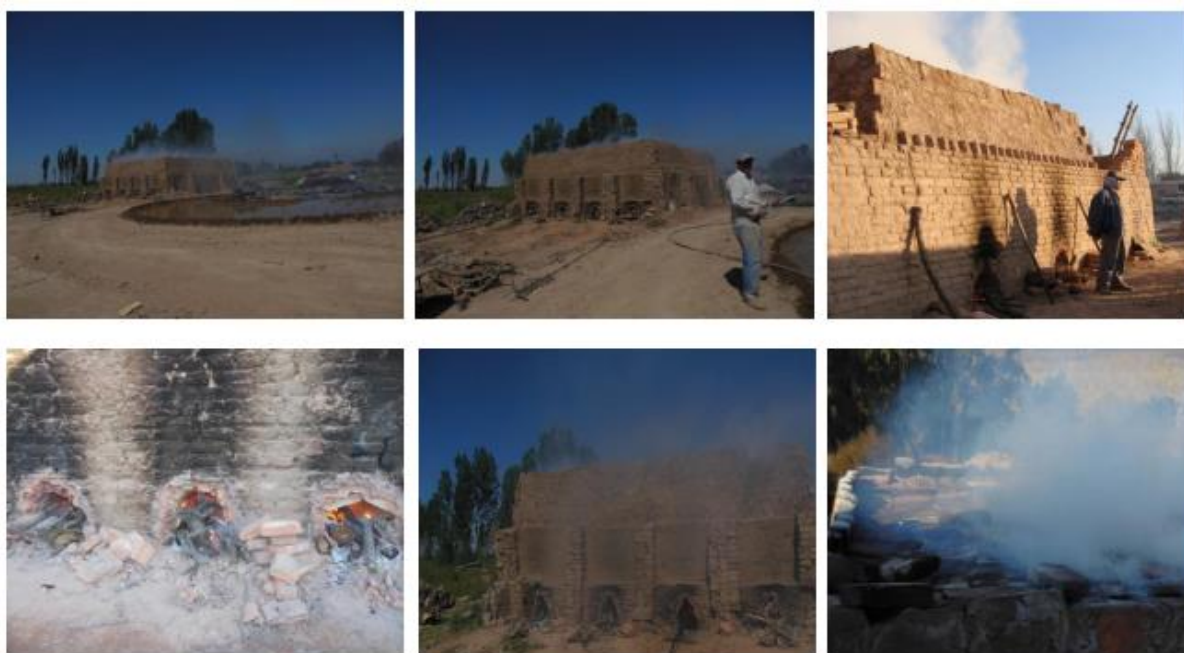
Figura 7. Cocción de los ladrillos. Fuente: Estudio Socioambiental de la Producción de Ladrillos Artesanales en Mendoza desde la Perspectiva del Análisis de Ciclo de Vida (UTN)
