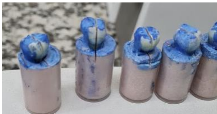
Imagen 14: Detalle de los cortes verticales pasando por el área restaurada
