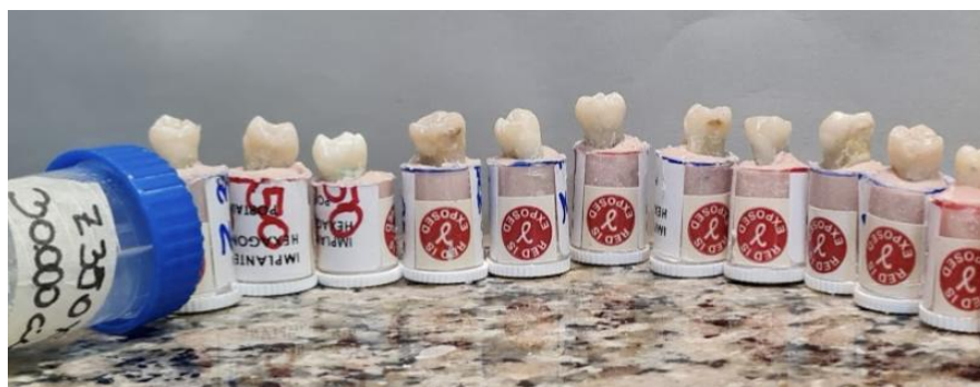
Imagen 13: Puede verse los elementos de muestra sumergidos en tacos de resina acrílica
