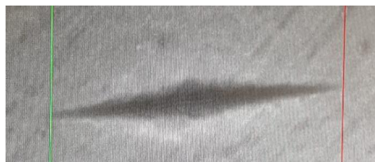
Imagen 4: Longitud de las diagonales mayores señaladas por dos marcas (verde y roja)
