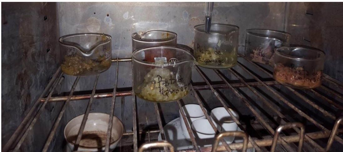
Figura N°13: Estufa donde se pueden ver los cristalizadores con las muestras ya deshidratadas (foto propia).
