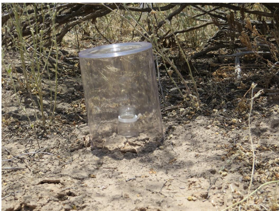
Figura 6: Cámara cilíndrica cubriendo trampa de NaOH
