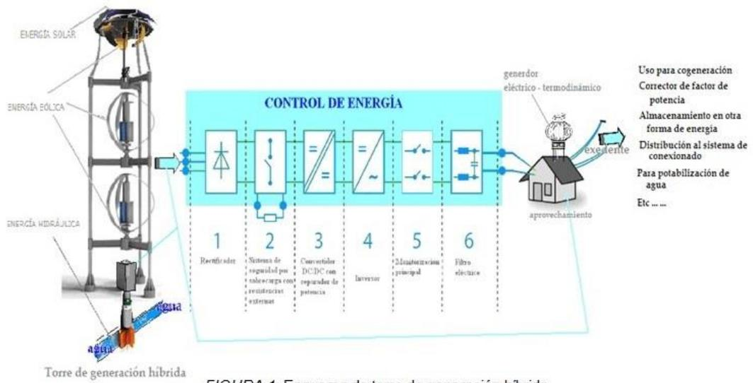
FIGURA 1: Esquema de torre de generación híbrida
