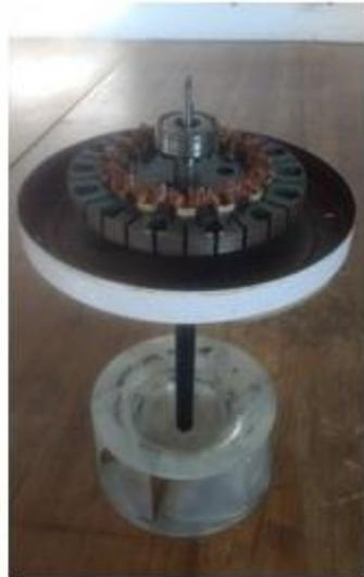
Turbina, eje y volante de inercia
